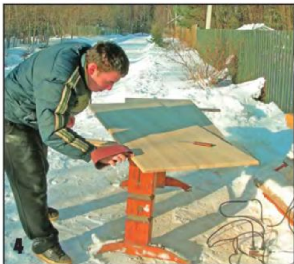
После фрезерования тщательно отшлифовали кромки столешницы.
