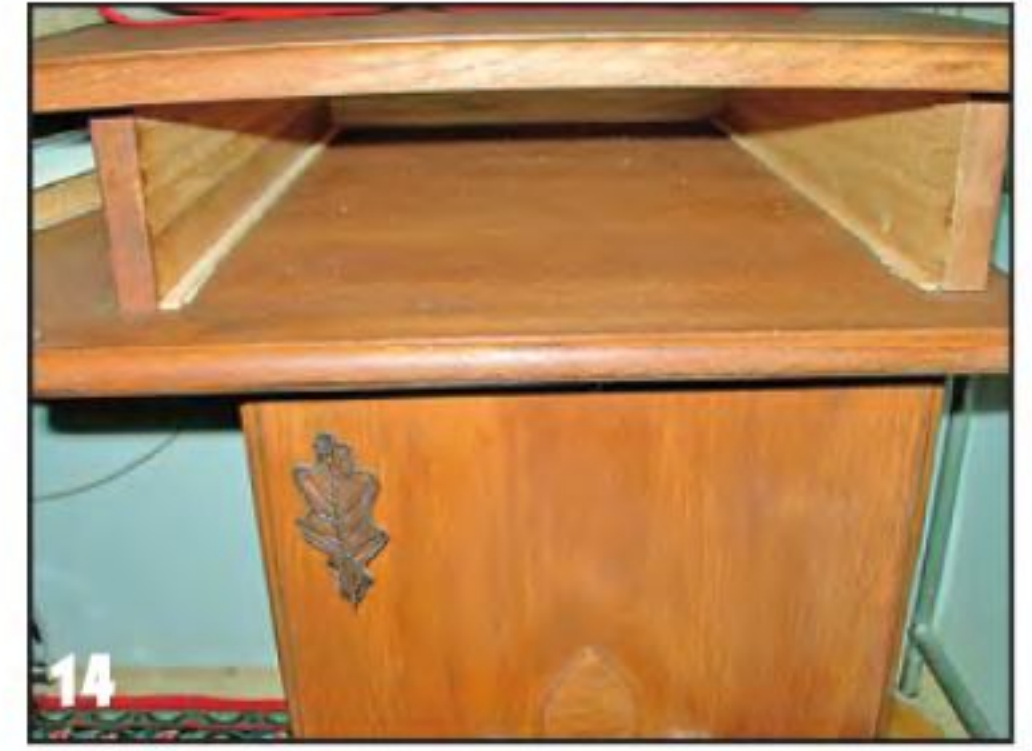
14 Вклеиваем в углы ниш деревянные планки-направляющие для выдвижных ящиков стола.
