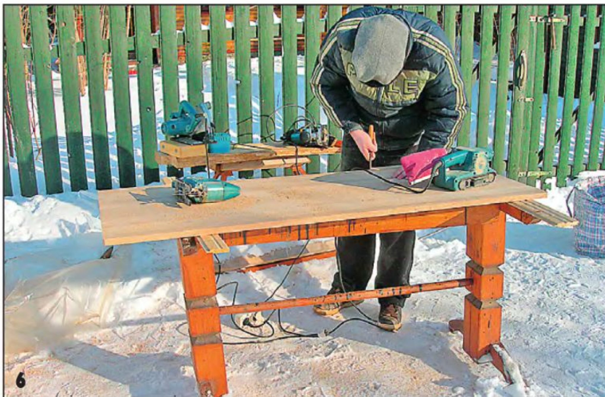
По размерам первой столешницы сделали точно такую же вторую столешницу, только с вырезом на передней кромке.
