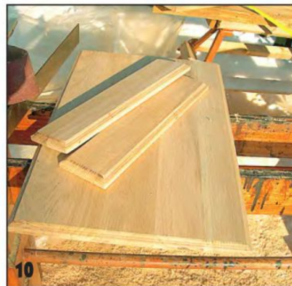
Фасадные детали — дверки тумб и лицевые панели выдвижных ящиков — готовы.
