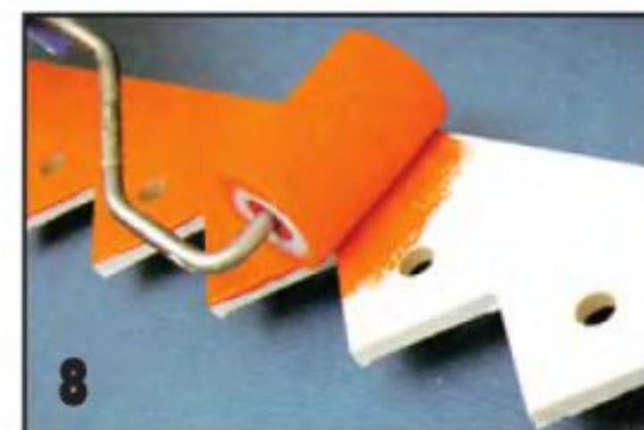
8 Когда базовая краска высохнет, подготовленный элемент «заборчика» с помощью обычного велюрового валика покрывают краской основного цвета.
