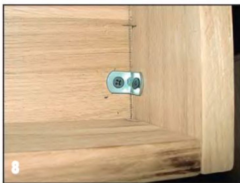
Соединив детали на шкантах, временно стянули их и зафиксировали мебельными уголками.
