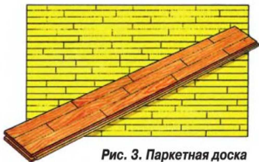
Рис. 2. Паркетная доска со сплошным верхним слоем (паркетная половица).
