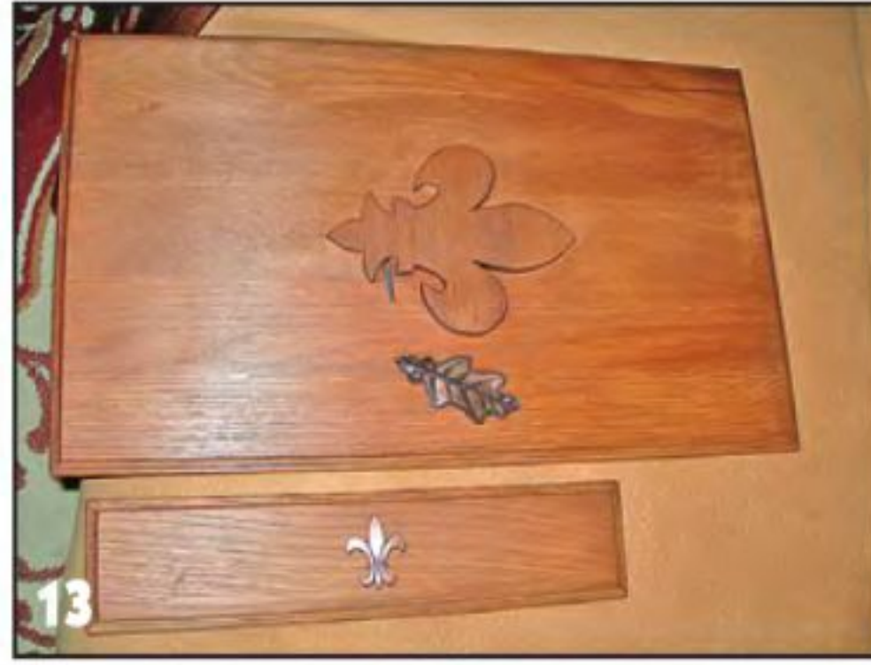
13 Фасадные детали покрашены. Крепим к ним фурнитуру.
